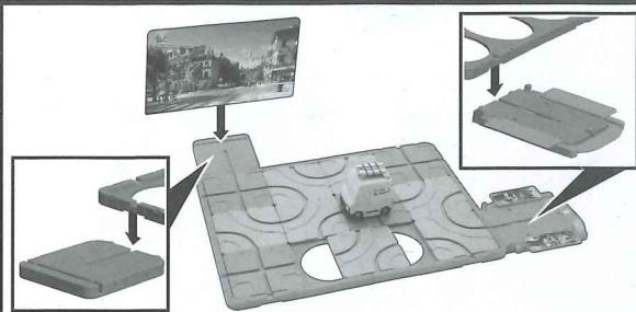
各フレームの裏面の四隅に、ゴム足を取り付けたあと、フレームをバチッと音が鳴るようにしっかりと組みます。(上図)
